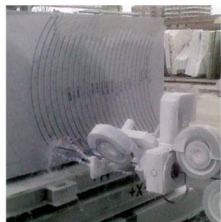
La machine à fil diamanté de la série CONTOUR PLUS peut réaliser n'importe quel façonnage en contrôlant 4 ou 6 axes, c'est-à-dire travaux d'art funéraire, formes cylindriques et coniques en général. Grâce à la vitesse de coulisement du fil diamanté variable au moyen de l'inverseur de fréquence, on peut couper marbre, granit et pierre, simplement en changeant la vitesse par rapport à la dureté du matériel à couper, à la taille du bloc et au fil diamanté utilisé.
